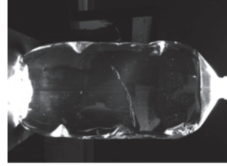
► CB-27042-R 清晰的将压痕成像出来,对比度明显
