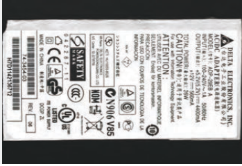
► CB-19320-W 判断标签上字符印刷缺陷。用两条CB-19320-W在标签两侧倾斜一定角度照射,标签上的字符不仅能与背景形成明显对比,而且光线均匀
