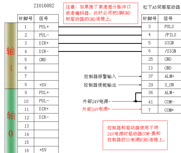
图 28 低速差分脉冲接线参考图
