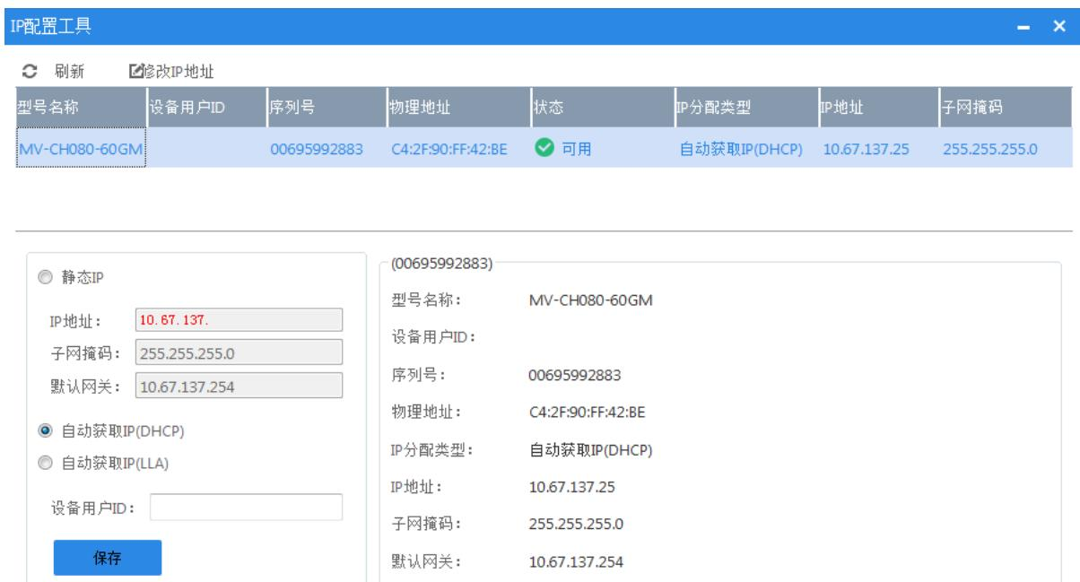
图3-1 相机 IP 配置
