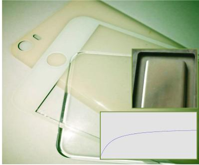
3D 玻璃检测、陶瓷后盖、石墨模具曲面轮廓、弯曲半径、平面度测量
