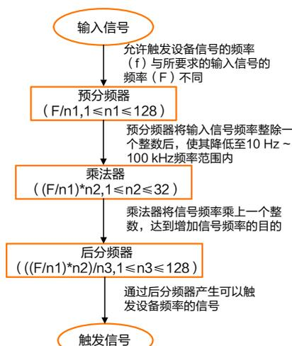
图6-3 频率转换流程图
