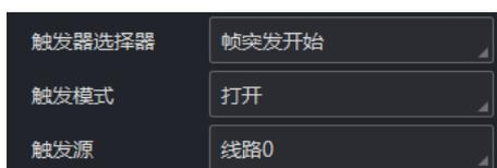
图6-2 硬件触发设置
