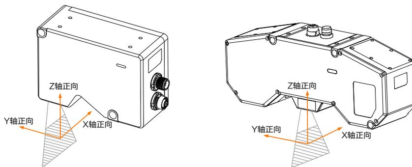
图3-4 设备三维坐标方向
